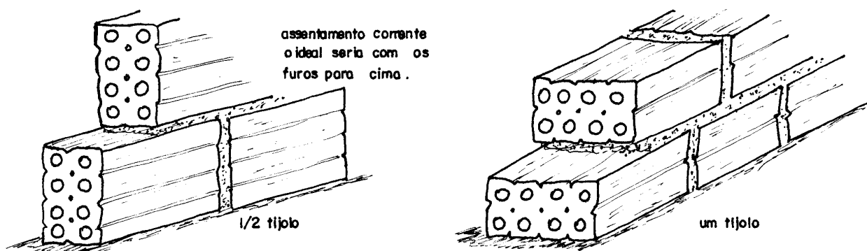
Figura 1 - Execução de alvenaria utilizando tijolos furados.
